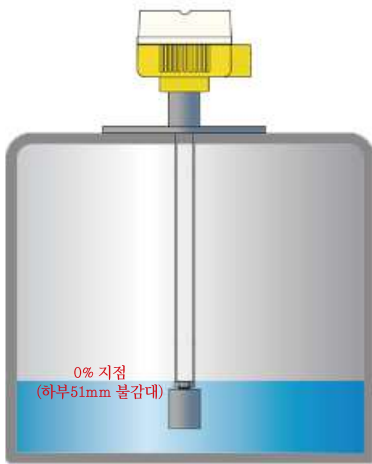
[ 비도전성 탱크일 경우 ] [ DCT-100-2 설치 방법 ]
