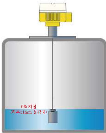
[ 올바른 설치 방법 ] [ DCT-100 설치 방법 ]
